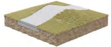
Sobre fundação em betão, ao nível do solo. On concrete foundation, at ground level.
